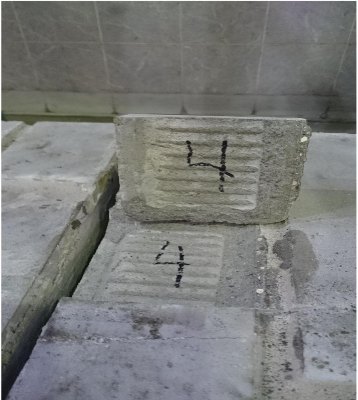
**РИС. 7 ОТРЫВ ПО КОНТАКТНОМУ СЛОЮ**
