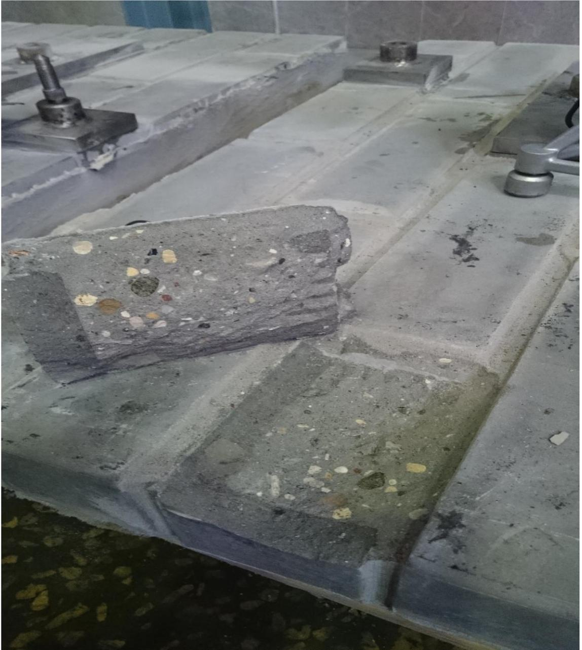
**РИС. 6 ОТРЫВ ПО БЕТОНУ**
