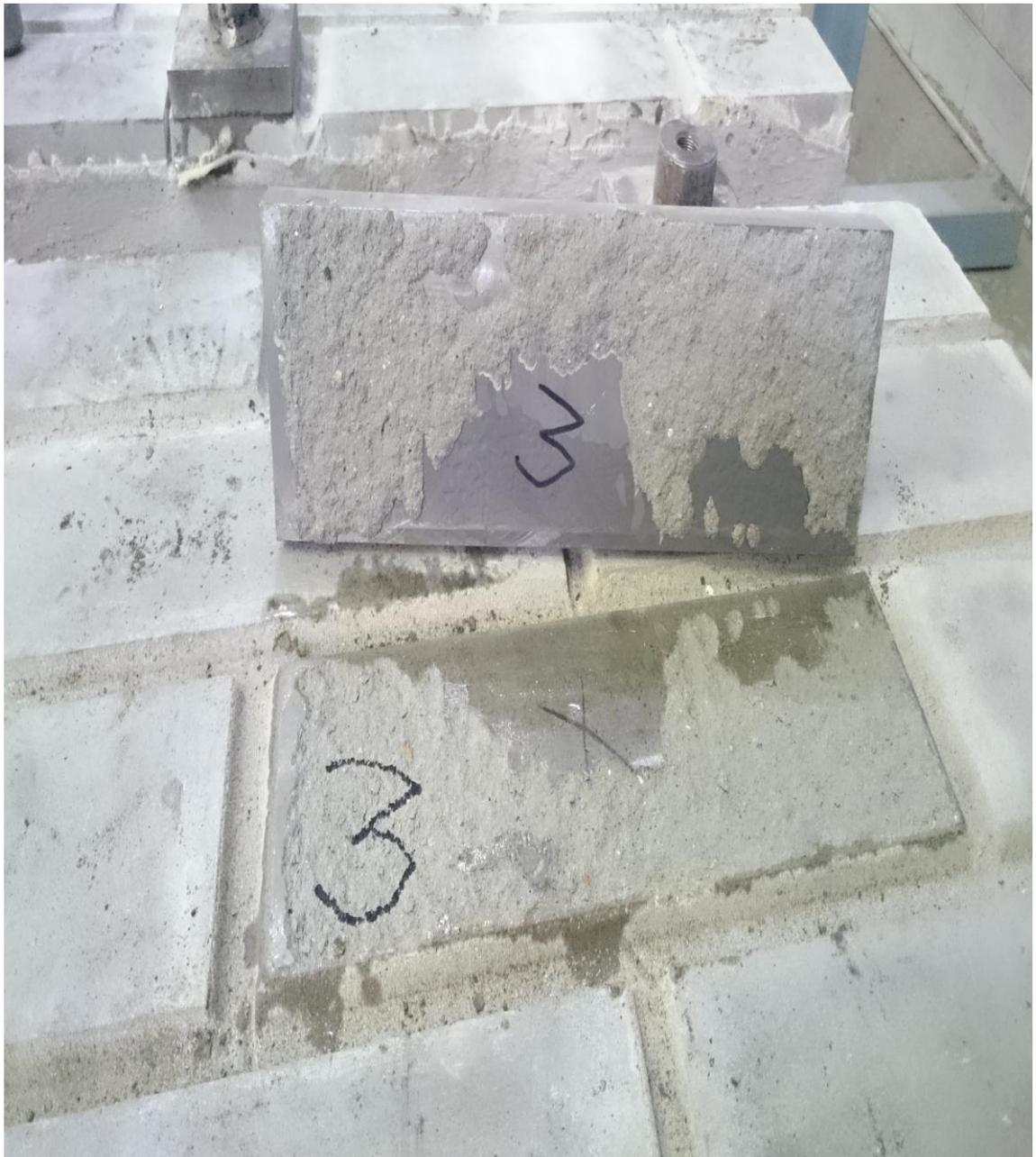
**РИС. 9 ОТРЫВ ПО АДГЕЗИОННОМУ СОСТАВУ**
